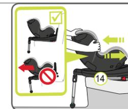
8. Scuotere il sedile di sicurezza per bambini per accertarsi che sia fissato correttamente e verificare una seconda volta che gli indicatori ISOFIX 14 siano completamente verdi.
