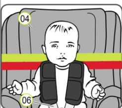
Un poggiatesta regolato correttamente 04 garantisce al bambino una protezione ottimale sul sedile di sicurezza: il poggiatesta 04 deve essere regolato in modo tale che le cinture a bretella 06 si trovino all'altezza delle spalle del bambino o leggermente più in alto.
